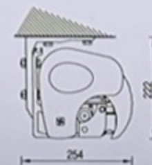
Ceiling installation with 31592 terminal bar Installation au plafond avec barre de charge 31592
