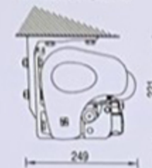
Ceiling installation Installation au plafond
