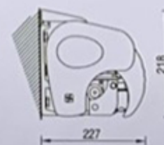
Wall installation with 31592 terminal bar Installation au mur avec barre de charge 31592
